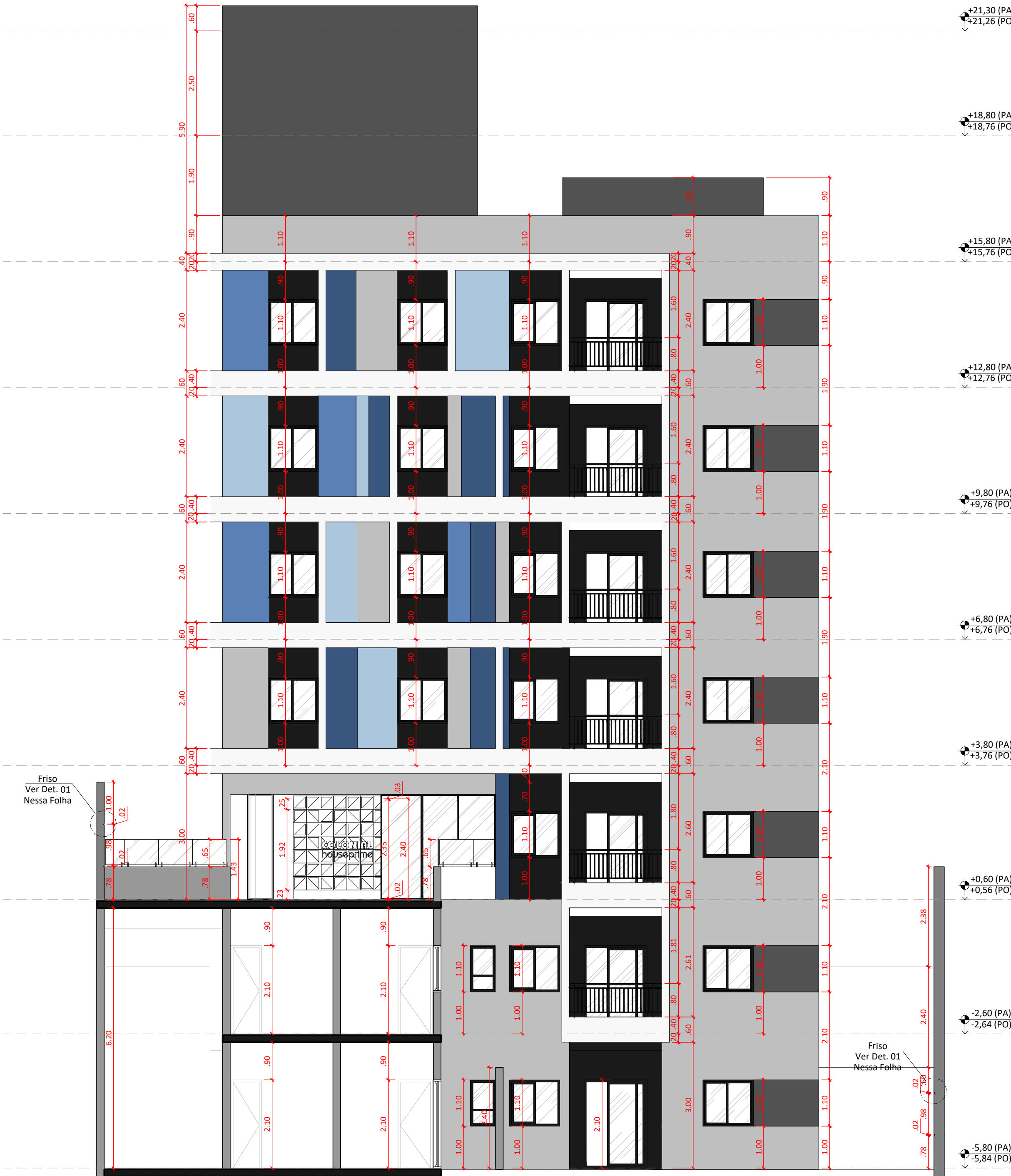
ELEVÇÃO 02 ALVENARIA ESC: 1:50
