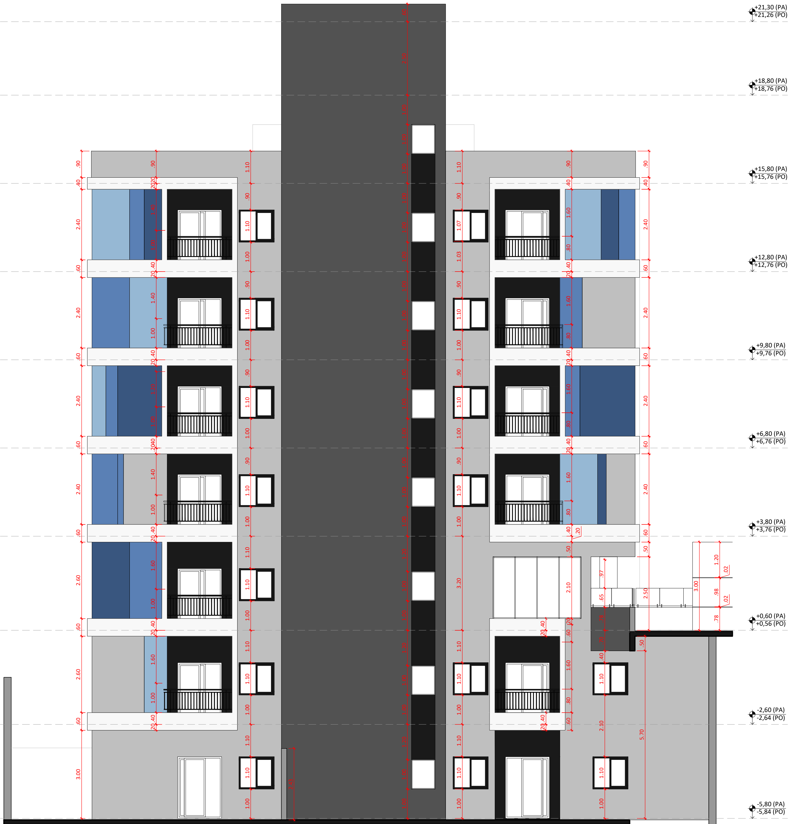
ELEVÇÃO 03 ALVENARIA ESC: 1:50
